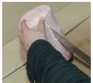
17 Attendre le séchage puis démouler
